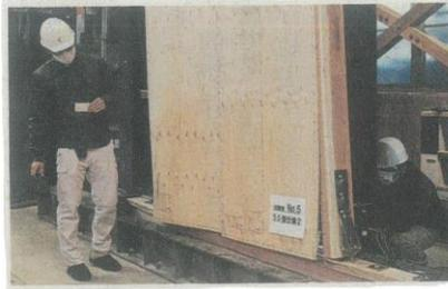
試験では縦二・五層、横一・八層の壁を押ししたり引いたりすることで負荷をかけた。約六トンの負荷がかかったところで枠から合板がはがれた。写真。建築基準
