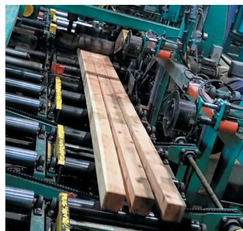
図1 製材直後に発生する曲がり
