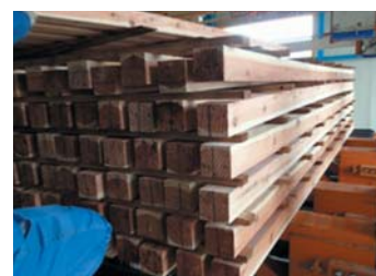
図2 棧積みの状況
