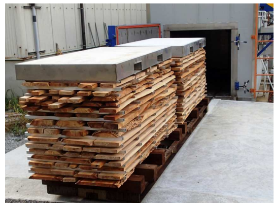
写真3 アベマキ材の人工乾燥
