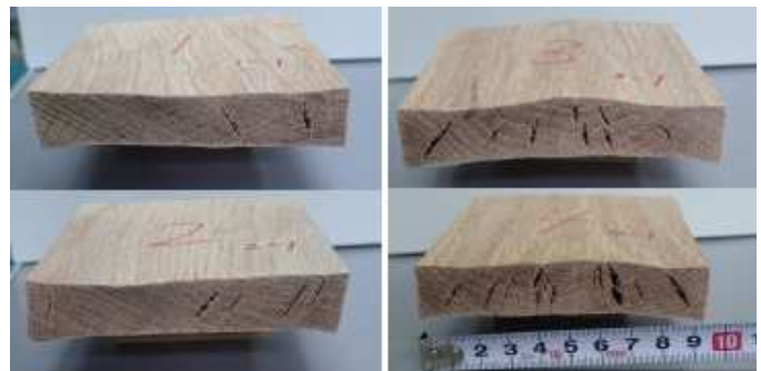
写真2 100℃試験による断面変形 左:辺材、右:心材
