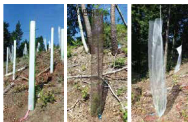
図1 試験に使用したツリーシェルター 左：ハイトシェルター、中：サブリガード、 右：幼齢木ネット
