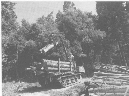
写真一 大型フォワーダによる積込・運搬
