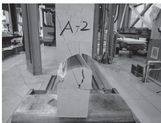
図-4. せん断破壊した試験体の破壊性状
