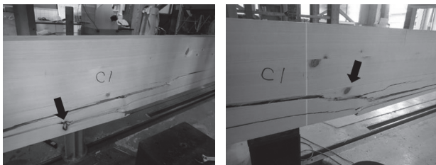
図-1. 試験体の破壊状況（引張側節からの曲げ破壊）
