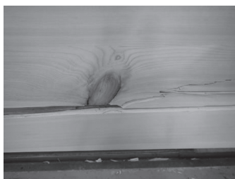
図-3. 試験体の破壊状況 （接着面に接する内層流れ節からの破壊）
