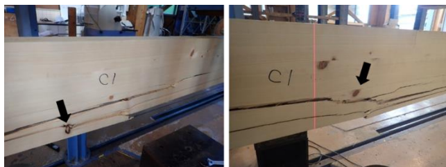
図-1. 試験体の破壊性状（引張側節からの曲げ破壊）
