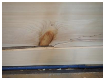
図-3. 破壊性状（接着面に接する内層流れ節からの破壊）
