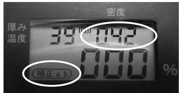
図-25 密度に加え検量線換算が組み込める機器
