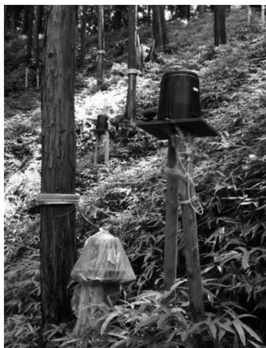
図-2. 林内雨量(右)と樹幹流下量(左下)の計測の状況
