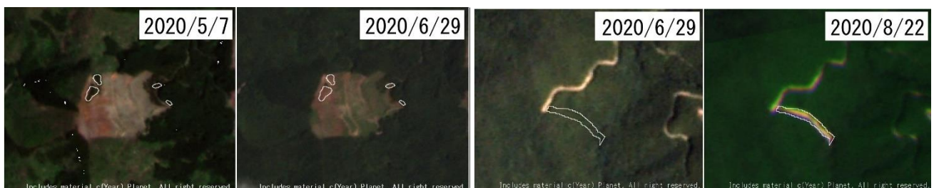
図-5. 変化点抽出結果例（左：伐採行為地、伐採前後、右：令和2年7月豪雨による崩壊地、被災前後）（國枝 2021）
