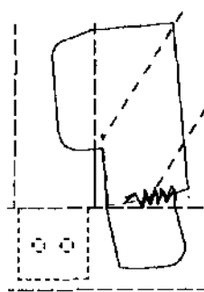
A プレート柱接点破壊引きだし B プレート土台部せん断破壊 C プレートボルト取付部曲げ破壊
