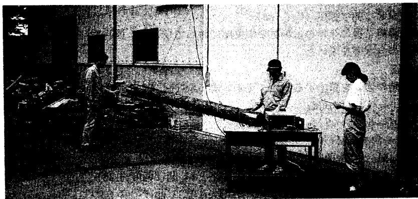
写真-1 原木のヤング係数測定方法
