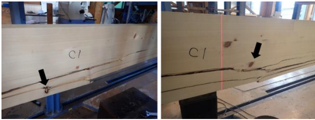
図-1. 試験体の破壊性状 (引張側筋からの曲げ破壊)
