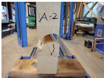
図-4. せん断破壊した試験体の破壊性状
