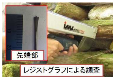
図一2 穿孔抵抗試験器（レジストグラフ）
