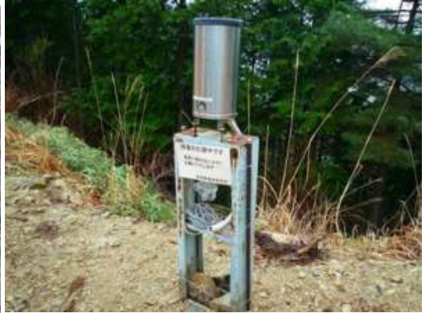
図-2 降水量用の転倒ます式雨量計
