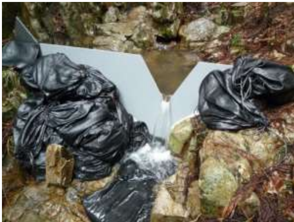
図-4 量水堰（左）と堰からの越流状況（右）
