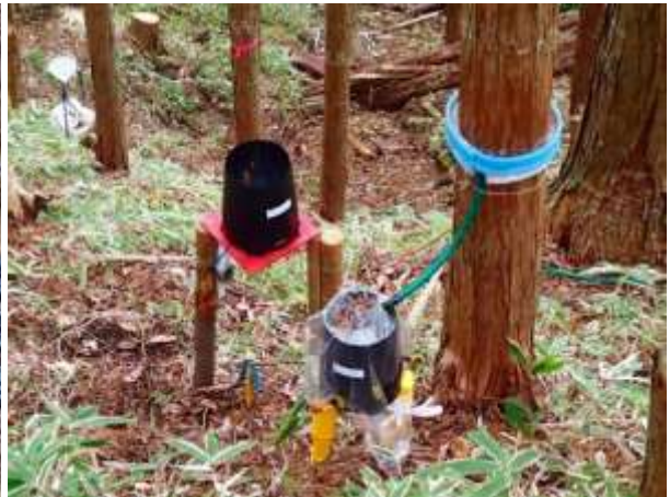
図-5 林内雨用の転倒ます式雨量計 （左上：樹冠通過雨用、右下：樹幹流用）
